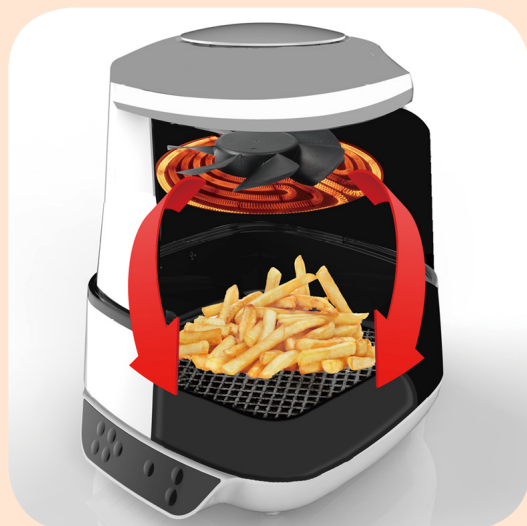
圖 1：空氣炸鍋的基本原理 — 發熱元件旁設有風扇，帶動熱空氣迅速循環。食物接近熱源，滴下的油會收集在網籃下方。
